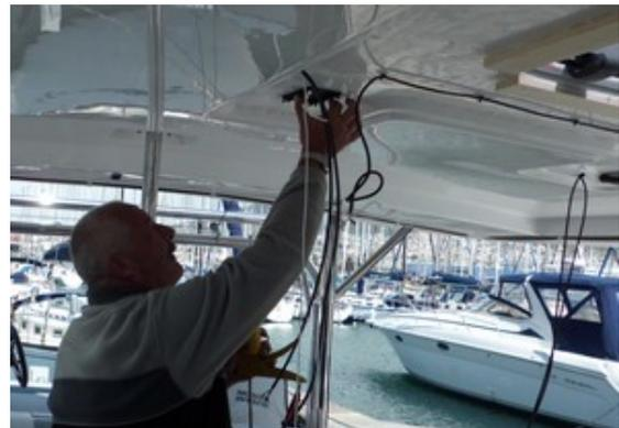
Sonst empfiehlt sich ein flexibles Rohr und evtl. eine weitere Bohrung in das Schiff bis zum Regler. Der Regler sollte luftig und trocken, möglichst nahe den Batterien, montiert werden. Sein Wärmefühler für die Batterie muss nur mit einem Dauerelastischen Kleber auf eine der Batterien geklebt werden. Die Kabel vom Regler werden ebenfalls in einem Rohrschacht mit Rundkabelschuhen an die passenden Pole der Batterie geschraubt.
