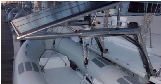
(behandelt mit Epoxyd und Lack) ein Auflager geschaffen. Achterlich stützen 2 Edelstahlstangen die 60kg Konstruktion (incl. Module) mit einer Neigung um 5% ab. Hier hilft ein Edelstahlschweißer vor Ort. Der Vorteil: Ein weiterer Schatten- und Regenschutz verlängert das Dach. Komplex und weit teurer wird es, wenn die Solaranlage auf die Davits montiert werden soll. Hier muss der Edelstahlspezialist einen
