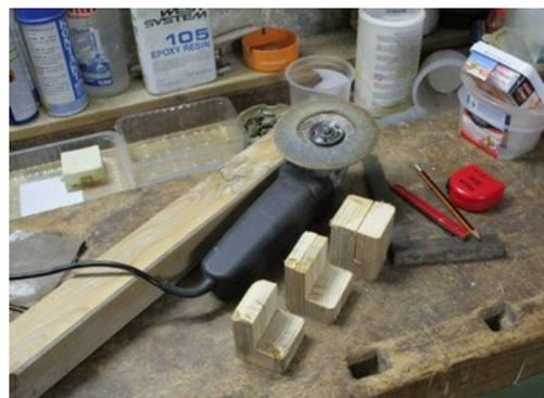
Dach legen und die Klötze unterschieben, nummeriert anzeichnen. Nun kann auch noch die Dachschräge angezeichnet und abgesägt werden.
